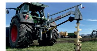
Neu am Standort Zennern ist ein **Erdlochbohrer** der Fa. Fliegl. Im Dreipunktbau ohne Oberlenker wird die Maschine per Zapfwelle angetrieben. Über 1dw kann der Bohrer seitlich geschwenkt werden. 1,20 m tiefe Löcher in 15/30/50 cm Durchmesser sind dank der drei verschiedenen Bohrer möglich. Fragen und Termine bitte an die Disponenten Christian Mardorf -30 oder Walter Baum unter 05683-9238-24.
