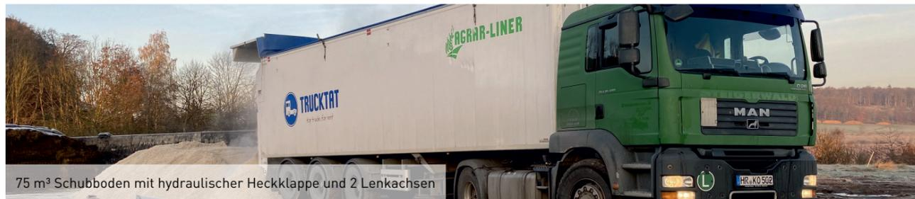
75 m³ Schubboden mit hydraulischer Heckklappe und 2 Lenkachsen
